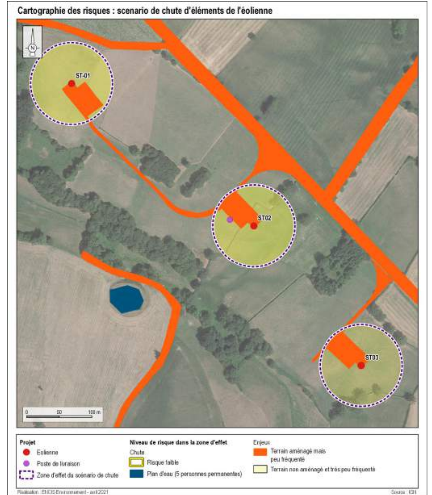
Carte 14 : Cartographie des enjeux identifiés dans les zones d'effet du scénario de chute d'éléments
